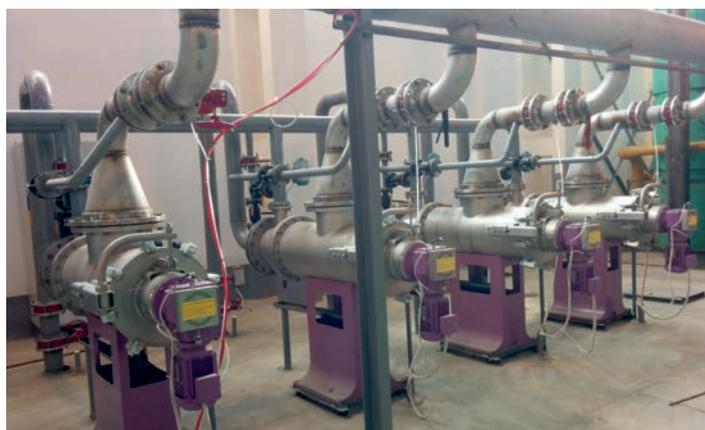
Рисунок 3: Пример установки для фильтрации очищенного сока
