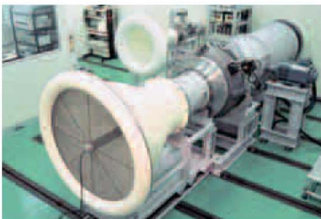
Стенд для исследования внутренних потоков в лопаточных машинах
