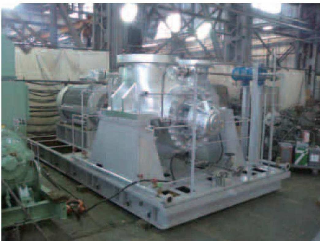
Насос охлаждения реактора № 1 для Таиланда (модель KS)
