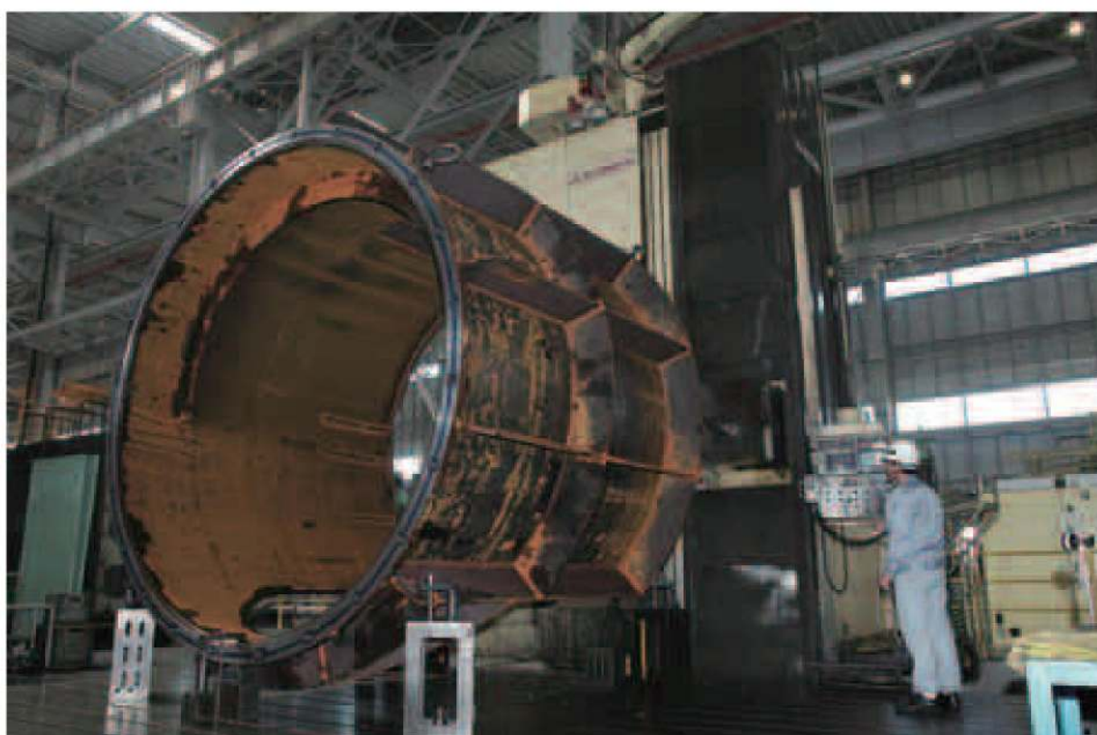
Обработка крупных деталей для насосов большого диаметра
