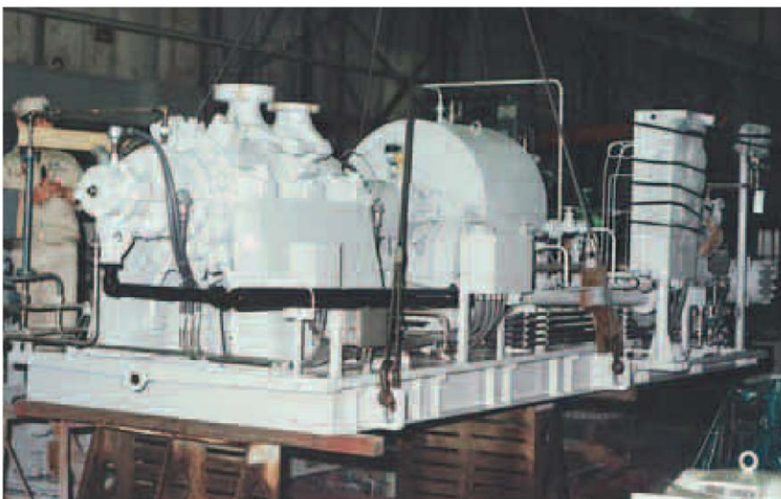
Насос для подачи карбамата для PUSRI, Индонезия (Model SSP)
