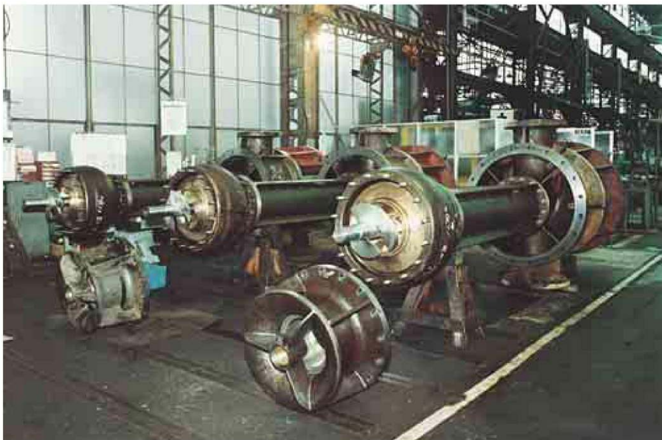
Сборка вертикального насоса (модель VPCS)
