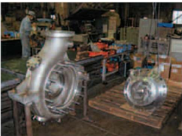
Сборка горизонтального насоса (модель UCW)
