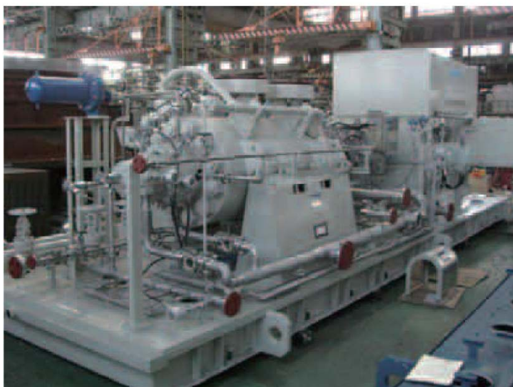
Насос и турбина для нефтеперерабатывающего завода в Китае (модель HDB)
