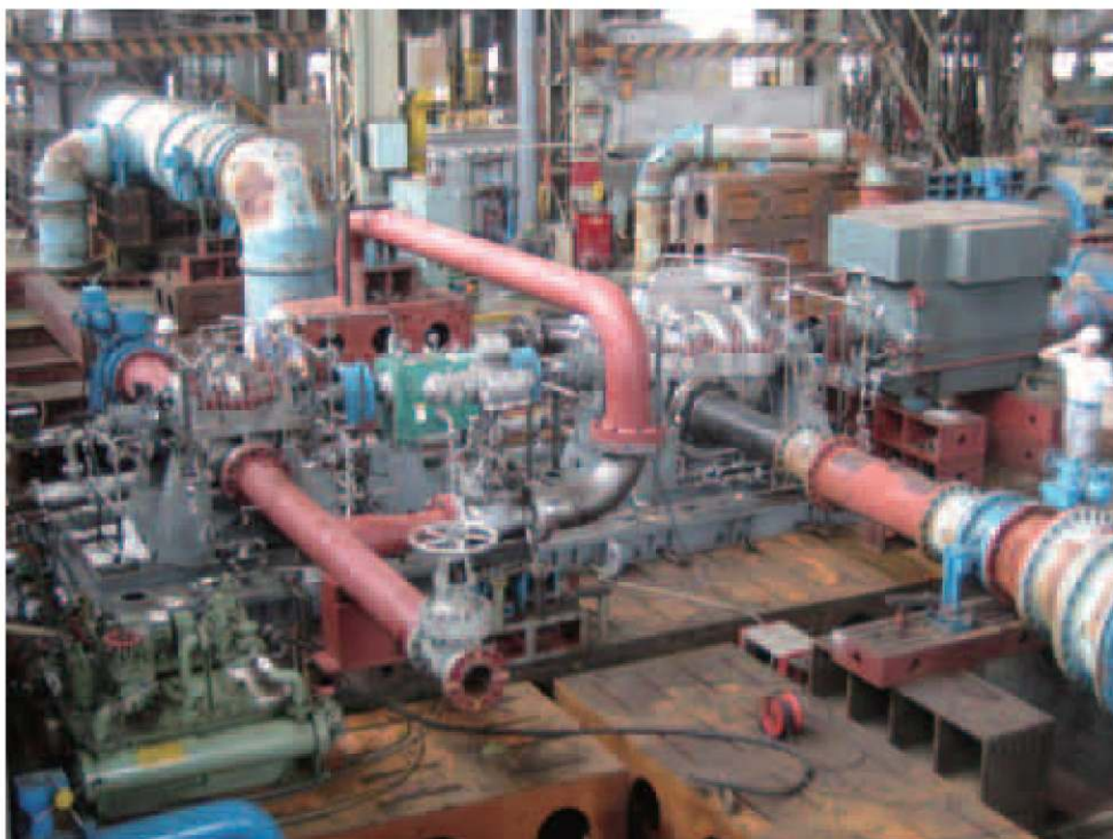
Эксплуатационные испытания насоса и турбины для завода по производству аммиака в Саудовской Аравии (модель SPD)
