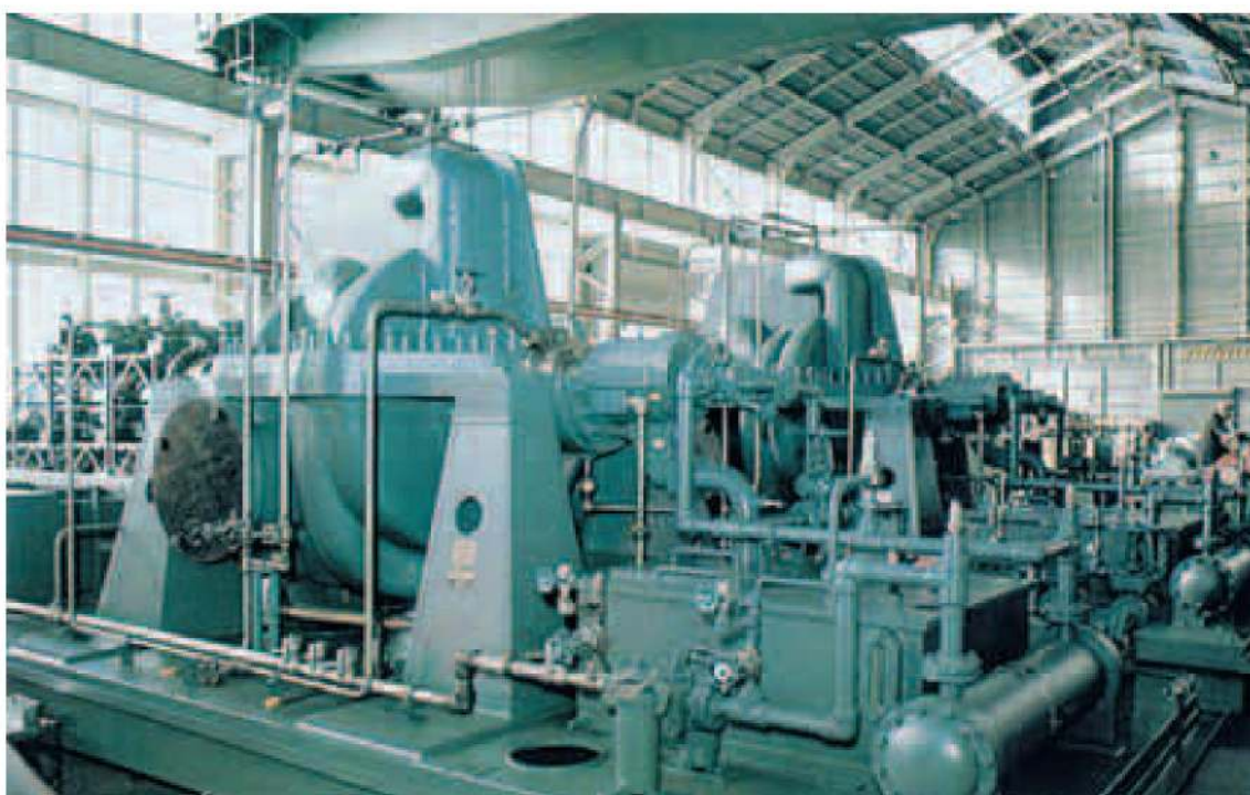
Насос для перекачки продуктов сжижения угля для SASOL, ЮАР (модель SPL)
