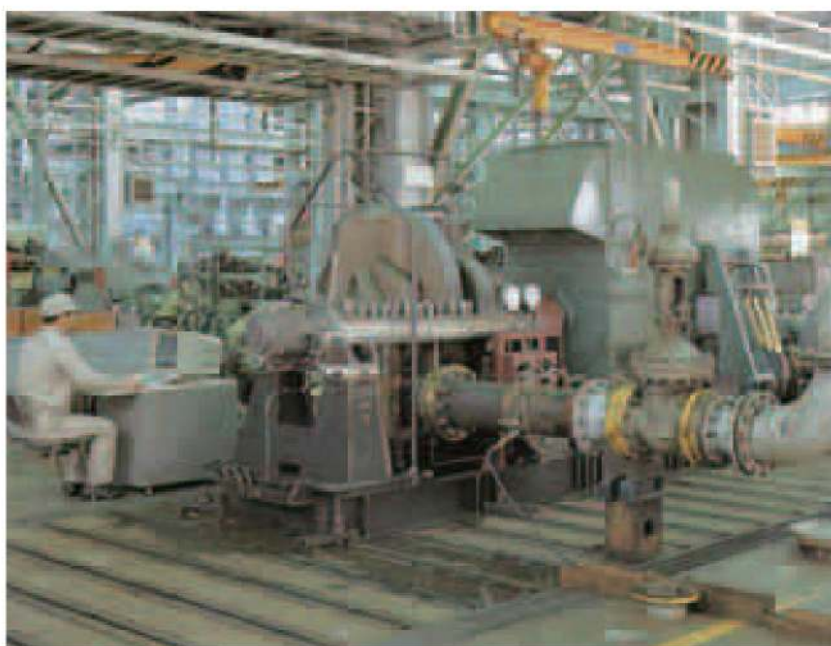
Автоматический стенд для рабочих испытаний (модель SPL)
