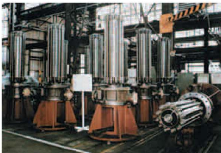
Насосы для закачки сжиженного нефтяного газа (модель ЕС)
