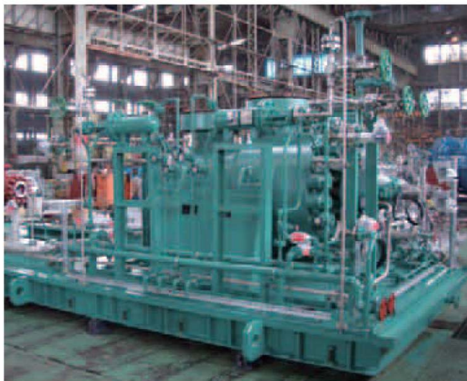
Насос для подпитки котлов на нефтеперерабатывающем заводе в Саудовской Аравии (модель DCD)
