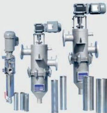
Скребокный фильтр Lenzing ScrapeFil - это полностью автоматическая система, работающая по принципу поверхностной фильтрации. Нефильтрованная среда попадает внутрь корпуса фильтра и проходит снаружи внутрь фильтрующей свечи.
